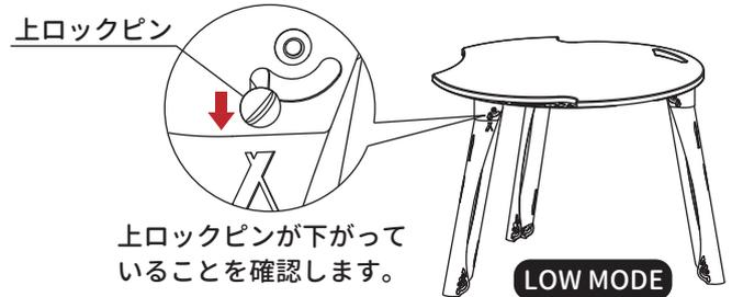
③ 接地した状態で上ロックピンを持ち上げながら内側の脚を振り出します。
