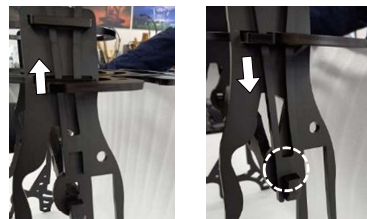
抜け止めパーツを一度上に引き上げてから・・・
